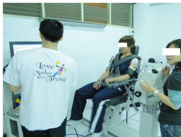
圖 3. 實際用等速肌力測定機(BIODEX)收取上肢不同角速度下最大肌力之情形：在測試之前先進行水平校正為 0 度，之後再進行垂直校正為 90 度，受試者在此 90 度間進行測試，測量受測者二頭肌及前三角肌在三種不同旋轉角速度下之向心及離心的等速肌力，分別為 60^{\circ}/s 、 180^{\circ}/s 和 300^{\circ}/s ，再以最大努力進行向心及離心收縮，測驗順序由低速至高速，不同速度間休息 30 秒，三個速度做完為一組，總共做三組，每組間休息 180 秒。測試的過程中給予受試者口頭激勵，計算二頭肌向心及離心的最大肌力表現和前三角肌向心的最大肌力表現。
