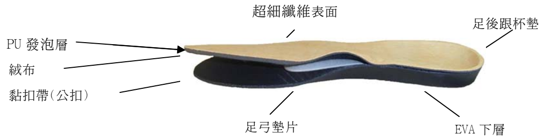
圖 1. 輔具組使用的鞋墊，上層使用高密度 PU 發泡材質做接觸足底的面材，此為軟的形狀記憶發泡材料層，夾層足弓墊為 PU 材質，下層為具有結構支撐性的 EVA 發泡層暨止滑層所組成。
