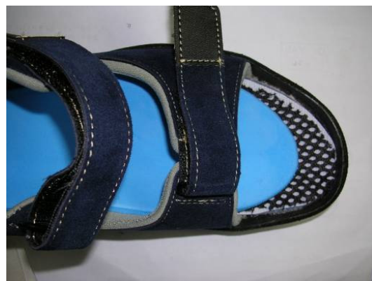
圖 4. 複合式模組測試片置於測試涼鞋內。由圖可見最下層為黏扣帶，上層為網布，再上層為測試片
