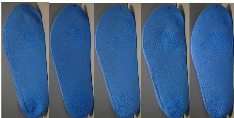
1 mm 2 mm 3 mm 4 mm 5 mm 圖 7. 以單一受測者為例，測試片厚 1~5 mm，250 步測試結果(底面)
