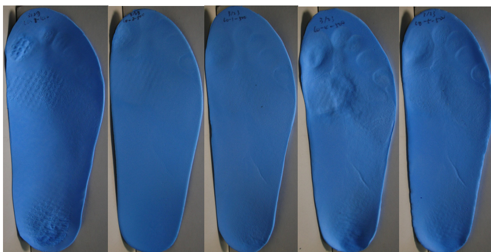
1 mm 2 mm 3 mm 4 mm 5 mm 圖 6. 以單一受測者為例，測試片厚 1~5 mm，行走 250 步測試結果(正面)
